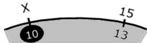
Analogamente, una incognita di cui si conosca la funzione  $X = A * B$  si può riportare anche nella forma  $B = X / A$  e sul regolo é risolvibile come segue :
