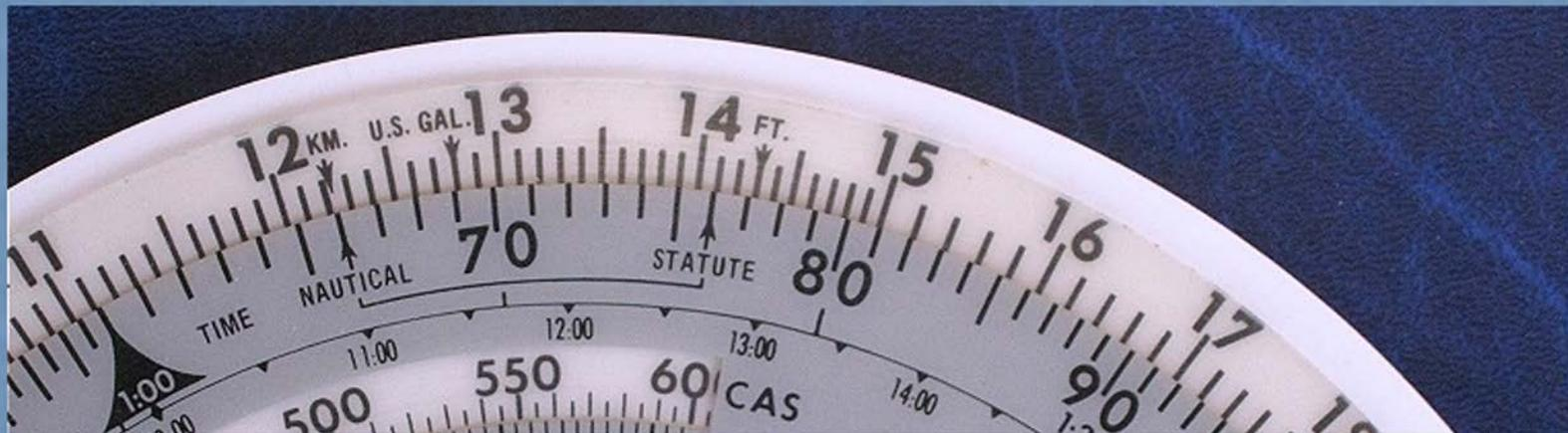
Si metta in corrispondenza l'indice NAUTICAL ( o STATUTE ) della scala inferiore, con l'indice Km della scala superiore per avere la relativa corrispondenza
