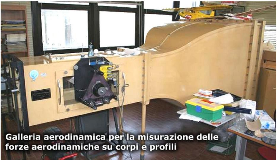
**Galleria aerodinamica per la misurazione delle forze aerodinamiche su corpi e profili**
