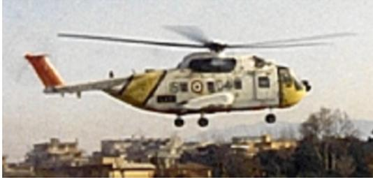
La rotazione delle pale corrisponde alla traslazione delle ali di un aereo nell'aria e sulle pale rotoriche si sviluppa la forza in grado di sollevare l'elicottero.
