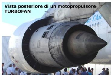
**Vista posteriore di un motopropulsore TURBOFAN**
