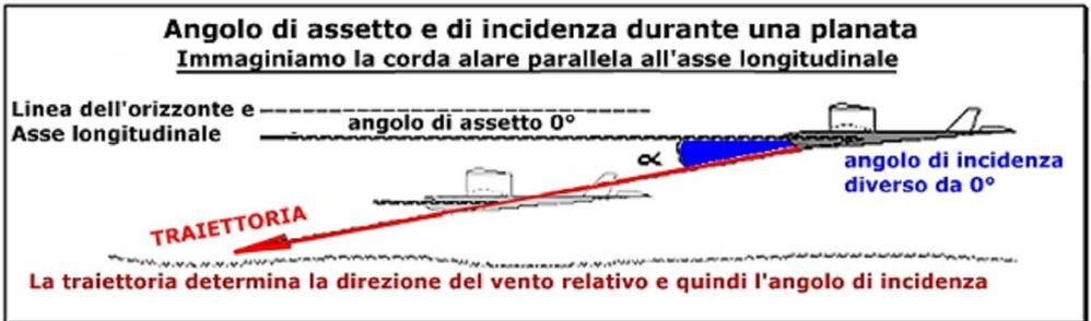
Normalmente un aereo vola con "angolo di assetto zero", cioè parallelamente al terreno, ma raramente in queste condizioni l'angolo di incidenza è zero: l'ala ha una sua incidenza che permette lo sviluppo della forza aerodinamica.
