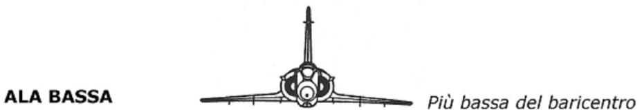
La distanza verticale dell'ala dal baricentro, determina una certa stabilità pendolare che si unisce alla stabilità dinamica laterale indotta dal diedro, ecco quindi che, se la forma in pianta dell'ala influenza il "rendimento aerodinamico" dell'aereo, **il diedro e la posizione verticale dell'ala, influenzano direttamente la stabilità sul movimento di rollio.**
