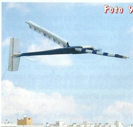
Ci sembra di essere tornati agli albori dell'aviazione: abbiamo trovato un modo per "volare" ma non abbiamo né potenza né un controllo sufficiente. Si pongono molti interrogativi e cerchiamo di valutare le variabili: rotazione asimmetrica delle ali, diverso bilanciamento, diverso calettamento del motore, effetto giroscopico delle ali rotanti...
