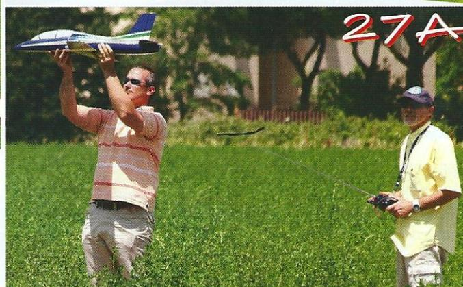
Con vento in prua siamo lenti rispetto al terreno e ho modo di apprezzarne la stabilità. Con il vento in coda non perde in manovrabilità e capacità di salita. Volava livellato con circa il 60% di manetta
